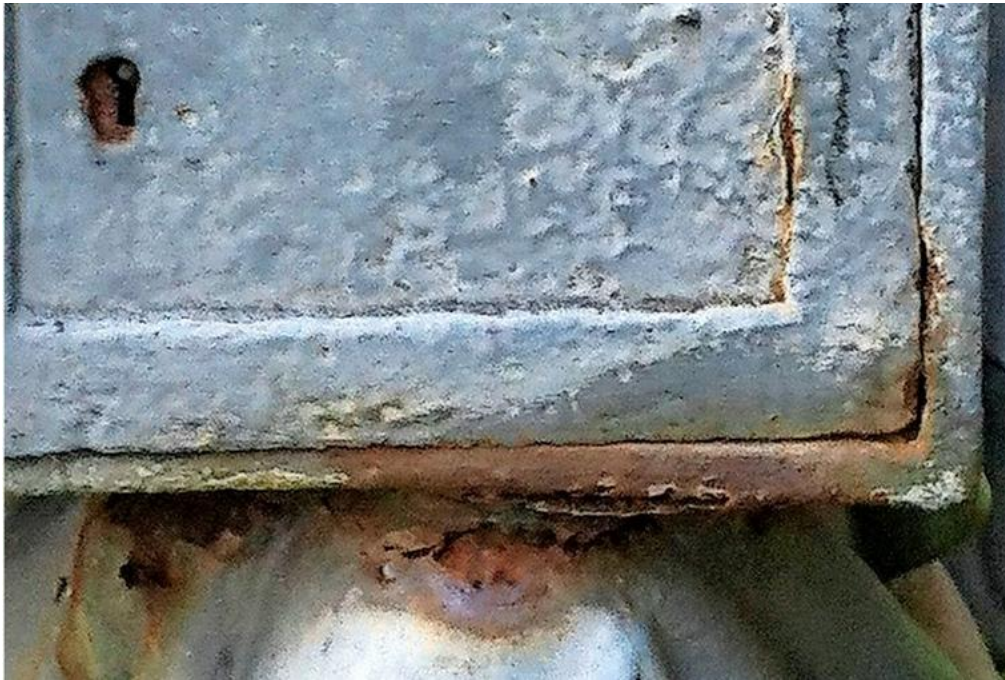
Rost am Spendenkasten. Quelle: r
